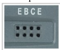
Test hFE tranzistoru
